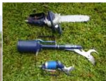
Sistema neumático para poda mecánica selectiva
