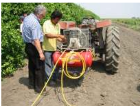
Sistema neumático para poda mecánica selectiva
